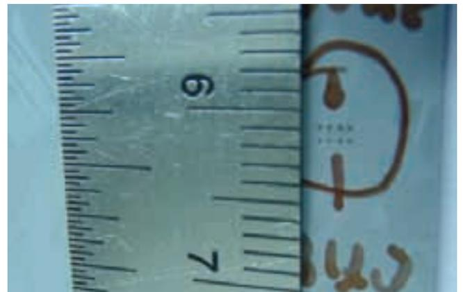
Microperforaciones de 40 micras de diámetro realizadas sobre silicio solar.
