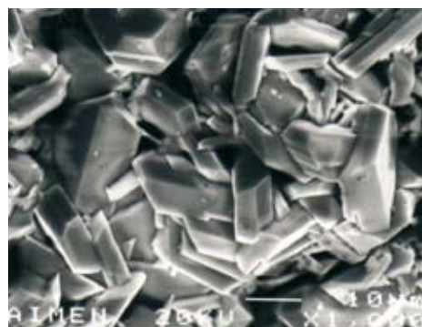
Figura 4. Microscopía electrónica de barrido. Detalle de la figura 3. Cristales hexagonales de cinc. 1000 X.
