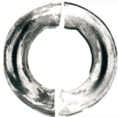
Figura 2. Codo 2B seccionado longitudinalmente. Pliegue en su parte interna. 0,9 X
