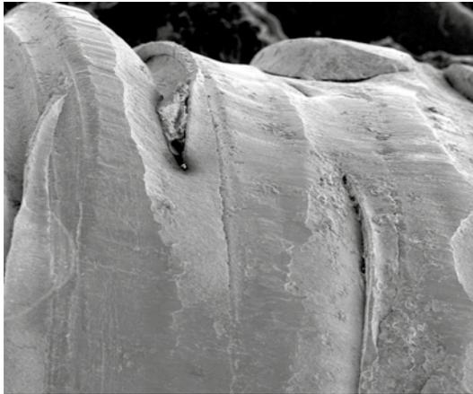
Dientes dañados. Microscopía electrónica de barrido. Originalmente a 45X.
