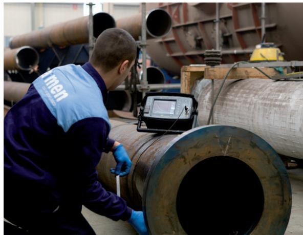
inspeccionado con el objetivo de detectar discontinuidades internas y superficiales. El sonido que recorre el material es reflejado, detectado y analizado para determinar la presencia y localización de discontinuidades. Desde el Área de Inspección se realizan:
