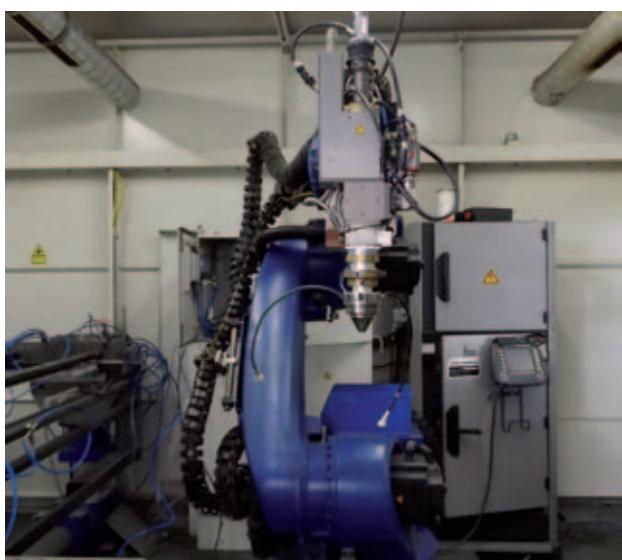
material empleado; el desarrollo de un sistema 3D de control de proceso y generación automática de trayectoria, que evitará la aparición de defectos (poros, grietas, etc.) entre las distintas capas; y la puesta en marcha de un sistema de post-procesado, que optimizará las tareas de mecanizado.
