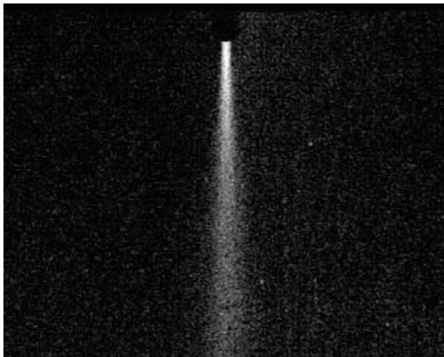
Figura 1. Imagen del chorro de partículas de polvo registrado con una cámara CMOS.
