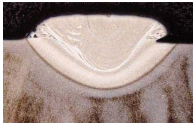
Figura. 5: Validación experimental del modelo obteniéndose cordones de geometría semejante pero con la aparición de grietas (arriba), por acumulación de tensiones residuales, y evitando la aparición de las mismas (abajo).
