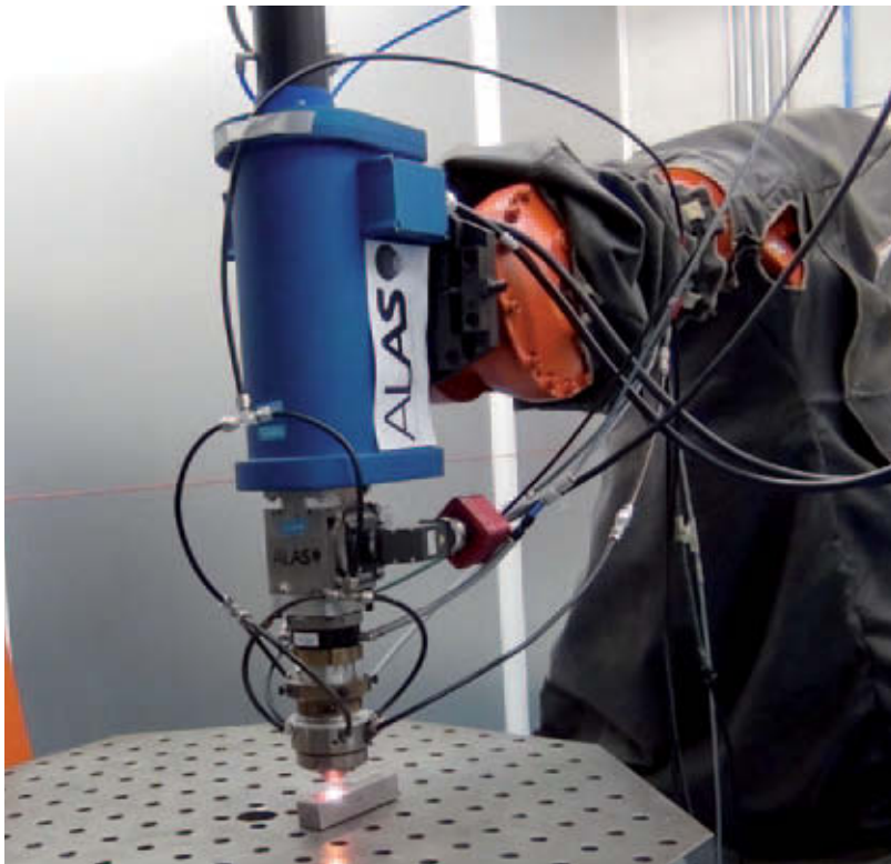
Cabezal adaptativo desarrollado en el proyecto ALAS
