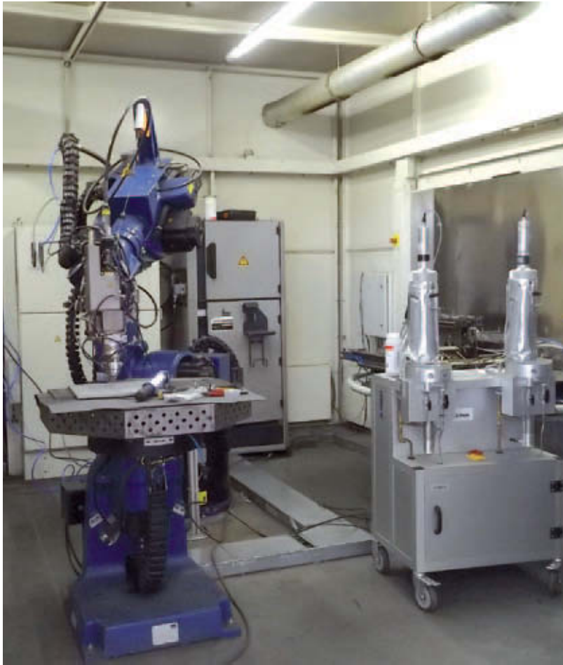
Celda de fabricación aditiva en las instalaciones de Hydracorte
