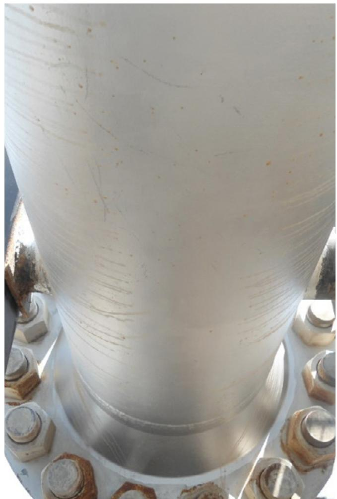
**Adecuación al servicio de fatiga Nivel 3 de API 579-1 / ASME FFS-1 de la carcasa de presión de un compresor centrífugo de gas**
